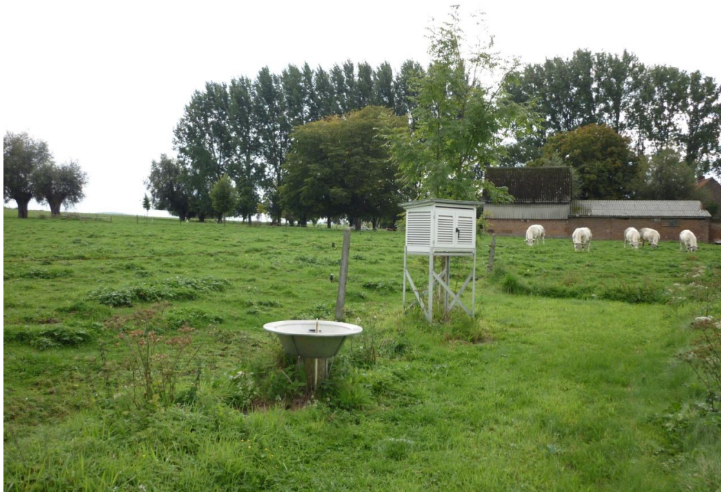
Ein typisches Beispiel einer von KMI in einem Privathaus installierten Klimastation. Im Vordergrund der Regenmesser zur Messung der Niederschlagsmenge und dahinter der thermometrische Schutzraum mit den Thermometern zur Messung extremer Temperaturen.
