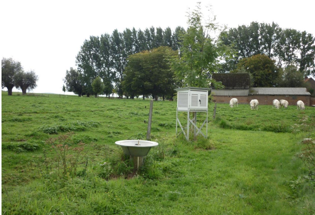
Un exemple typique d'une station climatologique installée chez un particulier par l'IRM. A l'avant-plan, le pluviomètre pour la mesure de la quantité de précipitations et, derrière, l'abri thermométrique qui renferme les thermomètres utilisés pour la mesure des températures extrêmes.
